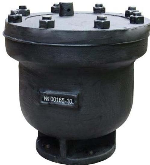
Вантузы предназначены для автоматического удаления воздуха в трубопроводе, а также для его автоматического выпуска при образовании вакуума. Воздух, скапливающийся в водопроводе, уменьшает его пропускную способность, нарушает работу насосов и является одной из причин гидравлических ударов при аварийном отключении насосной станции. В настоящее время ОАО «Завод «Водоприбор» выпускает 2 типа вантузов: ВМТ и В6.
