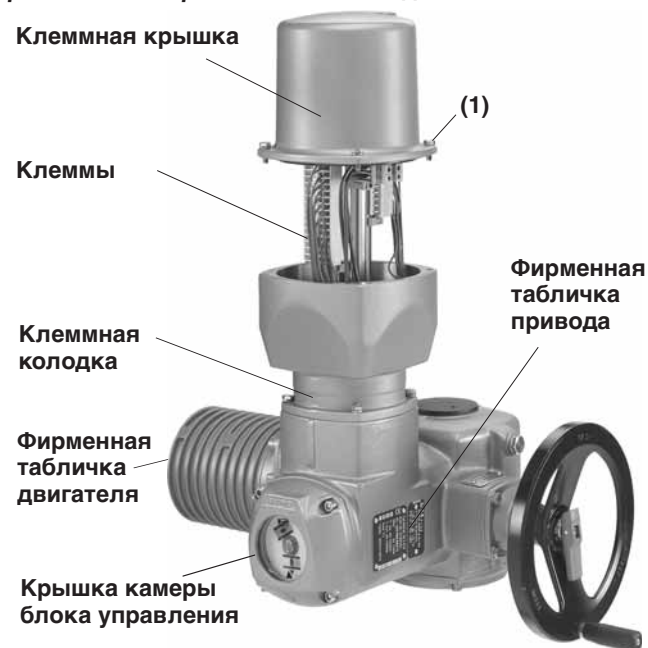
рис. G2: Штекерное клеммное подключение
