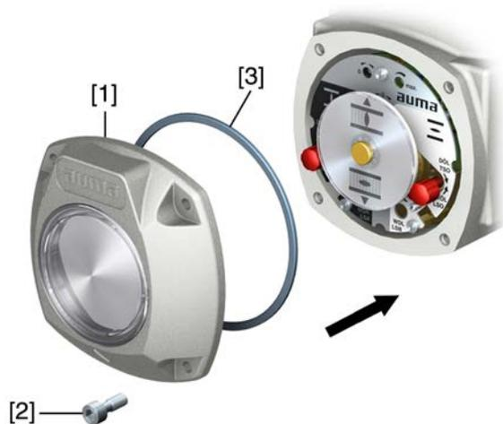
4. Снять крышку [1] отсека выключателей.
