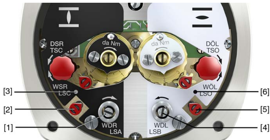
рис. 75: Регулирующие элементы концевого выключателя
