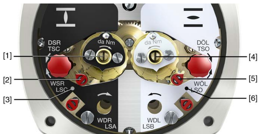
рис. 68: Регулировочные элементы концевого выключателя
