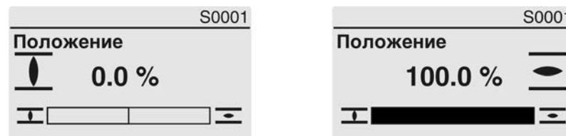
рис. 50: Достигнуто конечное положение ОТКРЫТО/ЗАКРЫТО
