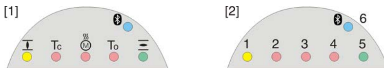
рис. 63: Расположение ламп и описание ламповой индикации
