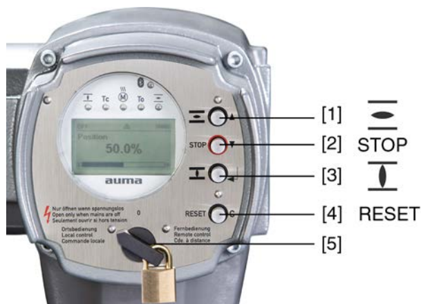
рис. 42: Панель местного управления
