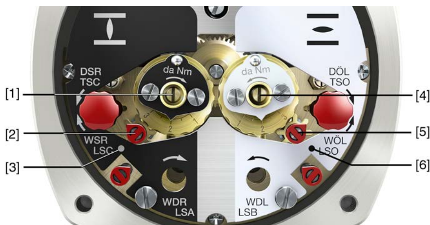
рис. 26: Регулировочные элементы концевого выключателя
